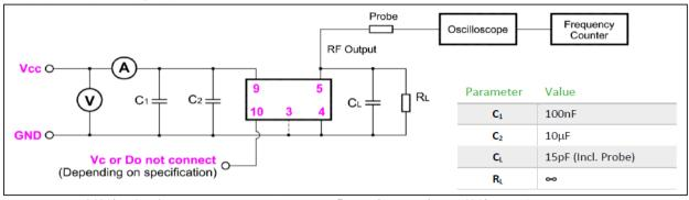
※回路接続の際にもVdd-GND間の一番近いところに『10μF』のコンデンサを接続して下さい。
