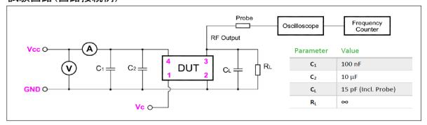
※回路接続の際にもVdd-GND間の一番近いところに $[10 \mu F]$ のコンデンサを接続して下さい。
